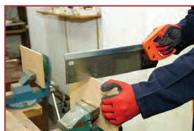
الف- بریدن قطعات با اره ظریف بر
