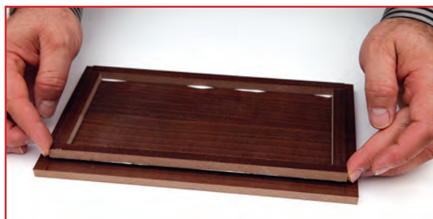
ب- قرار دادن زوار زیر در جعبه
