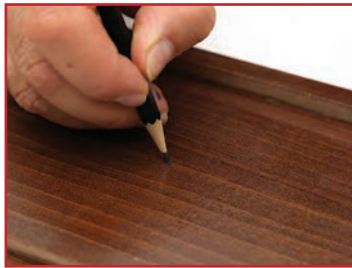
ب- مشخص کردن مرکز در با مداد
