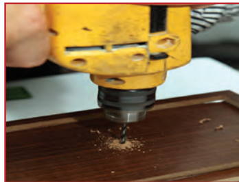
پ- سوراخ کردن در جعبه با دریل
