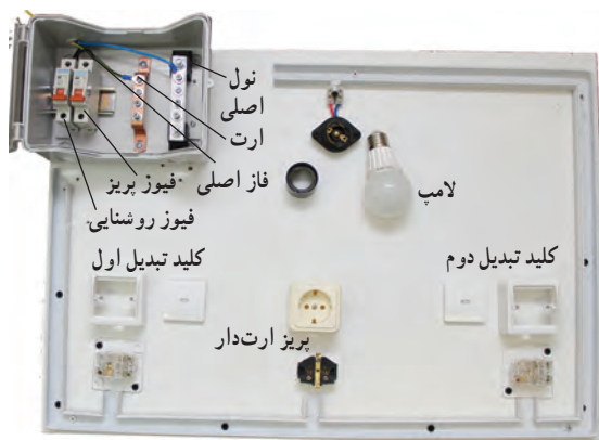
شکل ۲۰-۵- سیم‌کشی کلیدهای تبدیل
