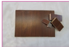
ج - ساخت قطعات پایه چوبی جرنقیل
