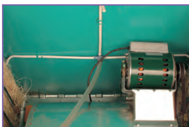
ح- آزمایش صحت مدار آب پخش کن
