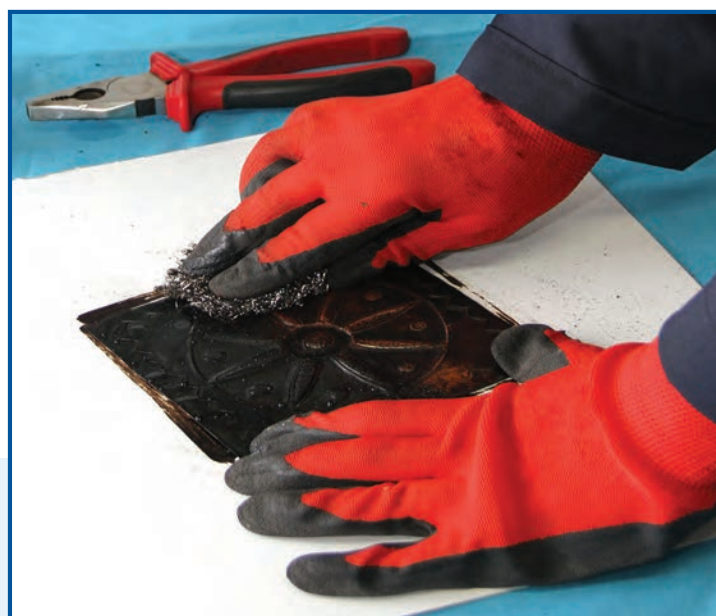
شکل ۱۱-۱۰- ساب زدن سطح پلاک مسی
