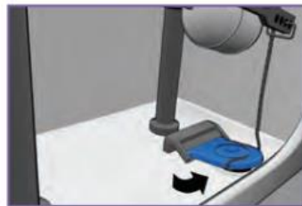
ج - اطمینان از نبودن زنجیر یا هر شیء خارجی در زیر درپوش تخلیه
