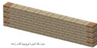
دیوار یک آهوی با نوع پیوند کله و راست
