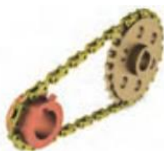
ب- ساز و کار حرکتی چرخ زنجیر
