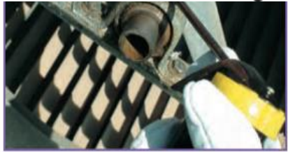
ث- روغن کاری یاتاقانها
